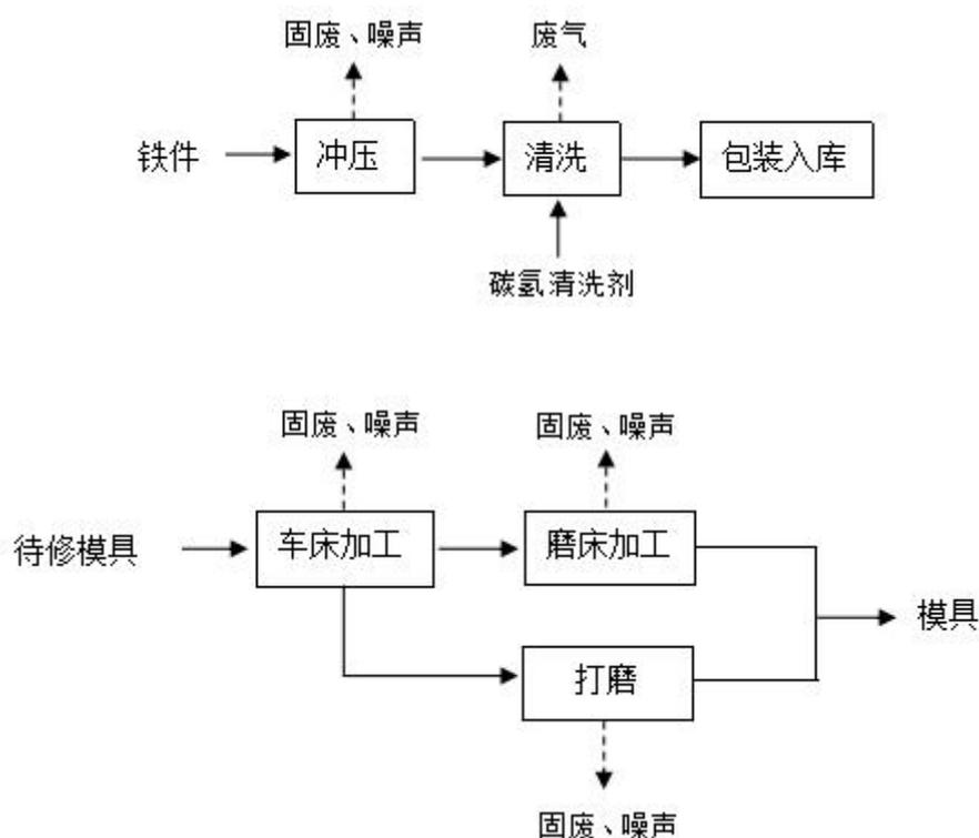
图 3-3 本项目生产工艺流程图
